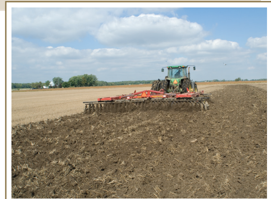
Régler les instruments de travail du sol et les surveiller pendant l'utilisation pour éviter qu'ils attaquent le sous-sol.
