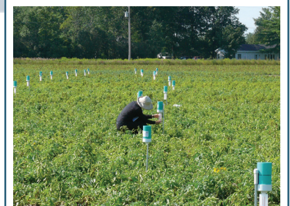
Installer des pluviomètres ou des récipients à des endroits stratégiques du champ pour mesurer la profondeur réelle (et le volume) d'eau fournie à la culture et son uniformité.
